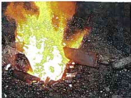
Obr. 20: Nyní je potřeba čepel zahřát na kalici teplotu...
