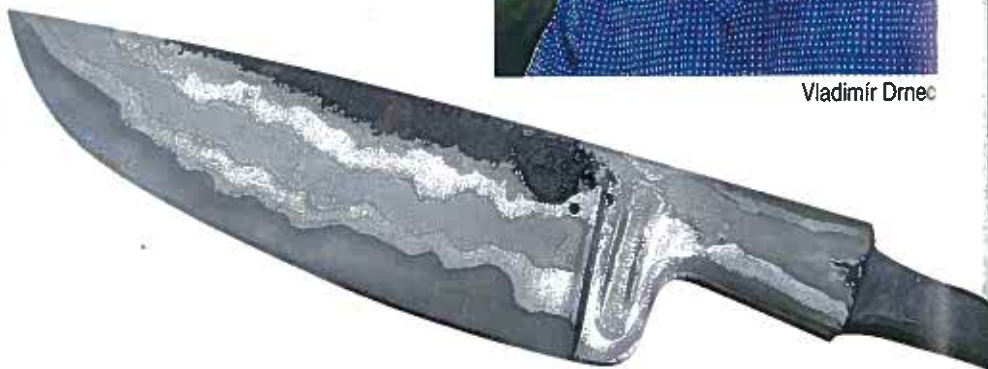
Obr. 26: Hotová čepel po zvýraznění jednotlivých vrstev leptem v lázni z FeCl_3
