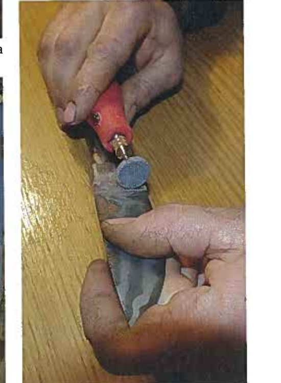
Obr 19: Vybrušování drážky v zástíte stopkovou frézkou. Drážka pomáhá k jistějšímu úchopu během vyvrhování
