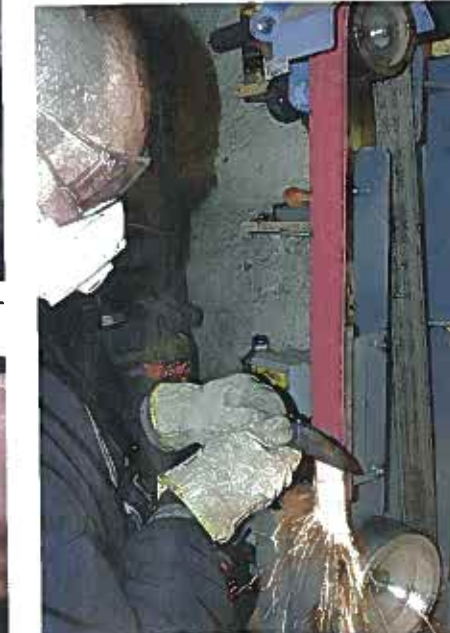
Obr 16: Výbrus čepele se provádí na pásce brusce
