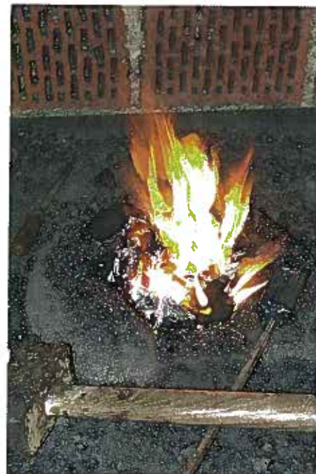
Obr 1: Připravený paket pro devítivrstvý sendvič
