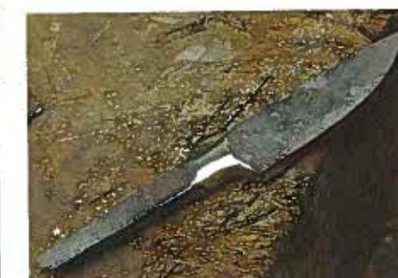
Obr 15: Z nevzhledného kusu opáleného železa se začíná rodit nůž
