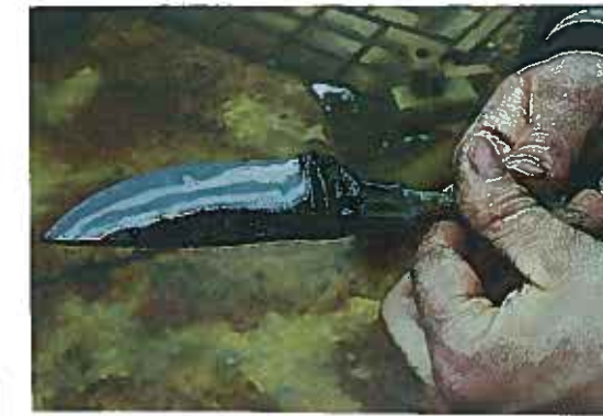
Obr 17: Po naleptání hrubého výbrusu je možná první kontrola uspořádání všech vrstev
