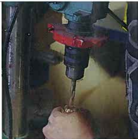
Obr. 24: Ještě vyvrtat díru pro trn čepel
