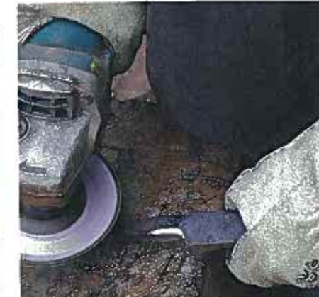
Obr 14: Vybrušování stopky a předsazení čepele
