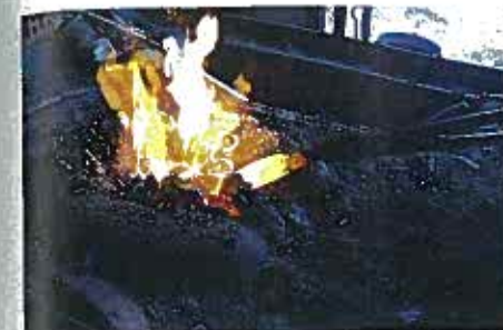
Obr 9: Mezi každou operací je třeba udržovat kovací teplotu, aby nedošlo k potrhání materiálu
