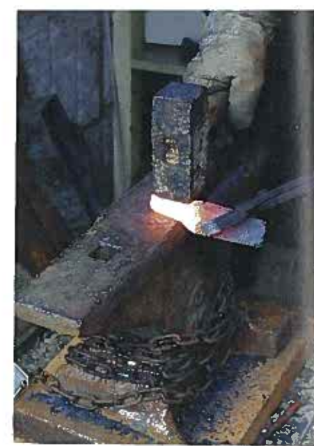
Obr 5: Vytahování stopky nože
