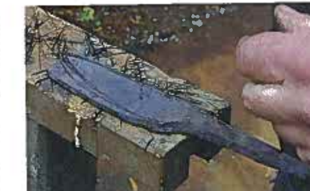
Obr 12: Po vyžhání sendviče se naznačí budoucí tvar čepele
