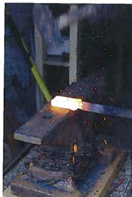
Obr 3: Pravidelnými údery začíná svařování
