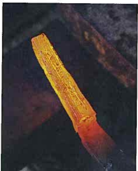
Obr 3: Pravidelnými údery začíná svařování
