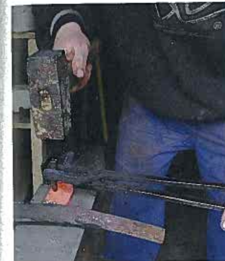
Obr 10: Označení polotovaru raznicí se značkou nožíře
