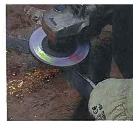
Obr 13: Začíná vybrušování hrubého tvaru čepele
